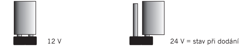
Obr. 3.6.1-2: Nastavení jumperu / přepínače pro výběr napětí
